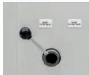
▶ Zmiana kierunku zrztu blachy za pomocą dźwigni (tył/przód)
