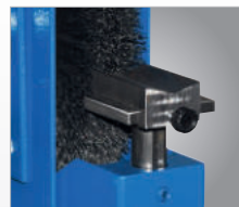
▶ Z regulowaną pryzmatyczną podporą detalu
