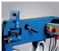
Naciąg taśmy za pomocą dźwigni
