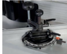
Bezstopniowa regulacja ogranicznika kątownego
