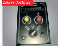
Automatyczny rozmagnesowywacz do zacisków magnetycznych
