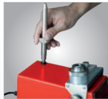
Sprawdzian głębokości wysunięcia elektrody - zapewnia precyzję i powtarzalność ostrzenia.
