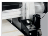
Regulacja wysokości zespołu szlifierskiego czytelna na skali
