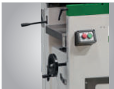
Regulacja stołu grubościówki poprzez pokrętkę ręczną
