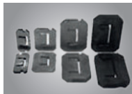
Różne noże do profili stalowych, siadła do wytłaczania i specjalne stemple i matryce dostępne na zamówienie
