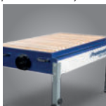
Stół drewniany zabezpieczający obrabiany przedmiot
