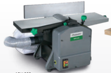
ADH 200 seryjnie z wbudowanym wyciągiem i workiem do zbierania wiórów
