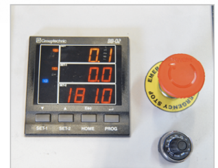
▶ Prosta obsługa, z cyfrowym wyświetlaczem dla bieżących wartości gięcia i do ustawiania parametrów
