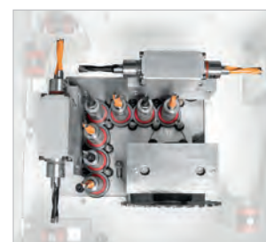
Głowica wiertarska wyposażona w pionowe i poziome wrzeciona umożliwia dużą elastyczność podczas produkcji
