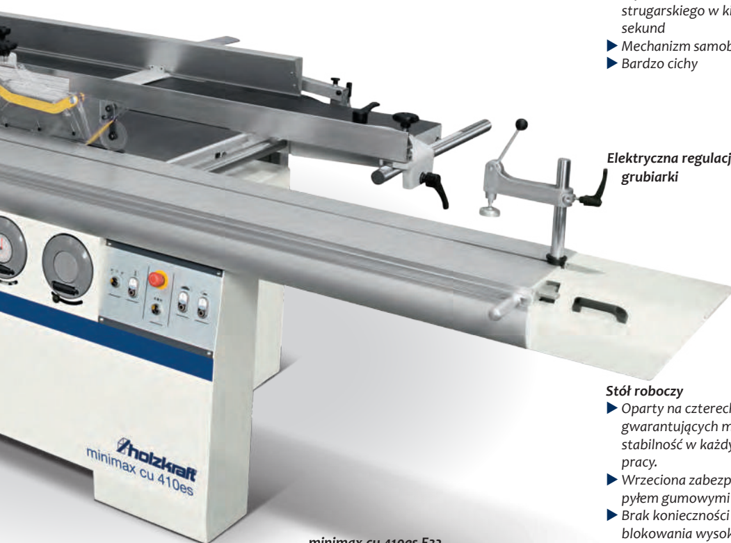
minimax cu 410es F32 ze stałymi pokrętkami z wbudowanym wskaźnikiem kątów.
