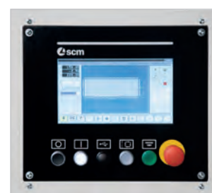
Sterowanie maszyną za pomocą 10 calowego ekranu dotykowego. Oprogramowanie Maestro dostępne opcjonalnie.
