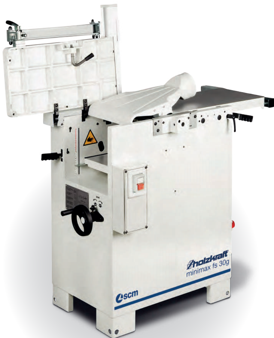
FS 30 genius TERSA Przebrojona jako strugarka grubiaraka
