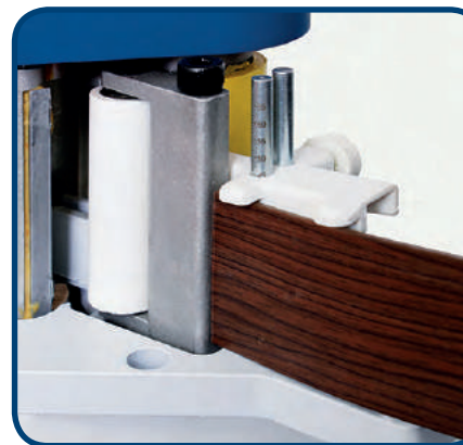
Szybkie ustawianie ogranicznika wysokości obrzeża.
