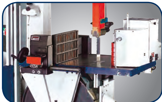
Mechanizm z pneumatycznym otwieraniem VSA 21 CP Mechanizm z pneumatycznym otwieraniem i bezstopniową regulacją prędkości VSA 260 CPM
