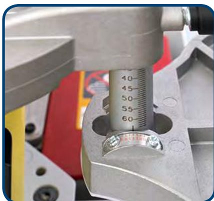
Wysokość elementu 10 - 60 mm odczytywana na skali. Płytę prowadzącą można pochylić o \pm 15^\circ co daje możliwość oklejenia krawędzi pod kątem.
