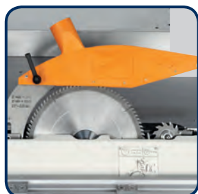
Podwójnie mocowany agregat pilarki
