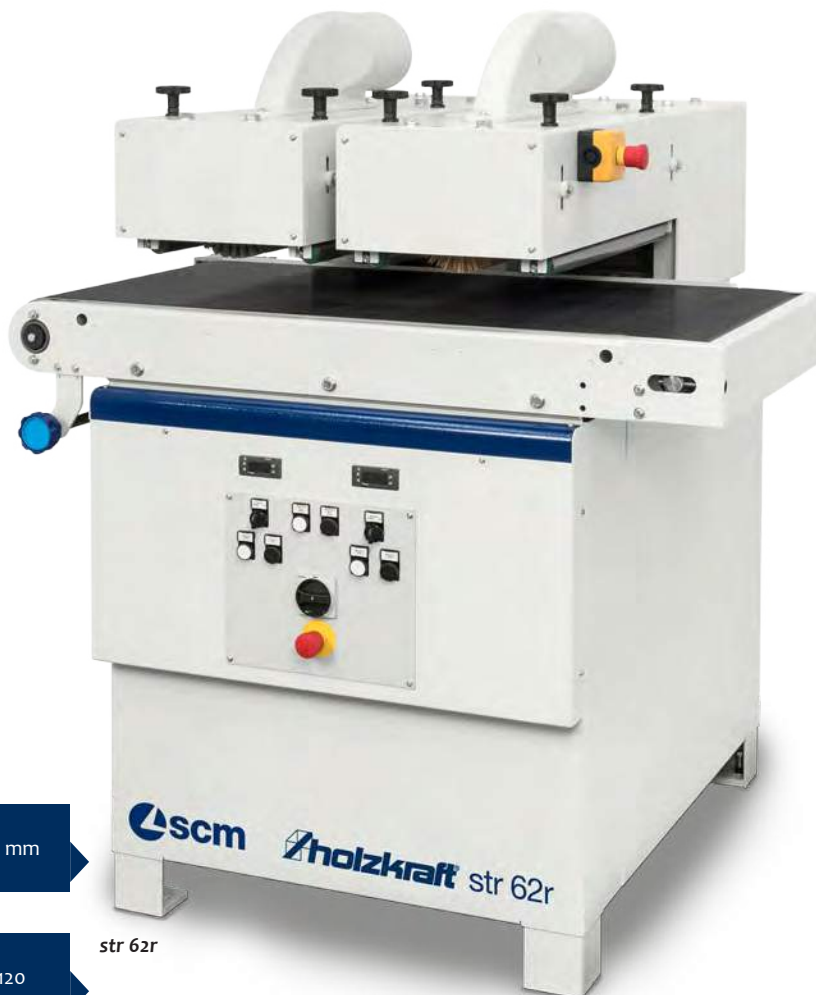
▶ Agregaty robocze mogą być uruchamiane indywidualnie
