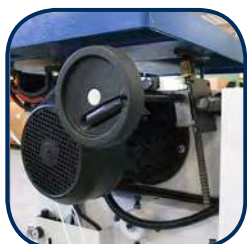
Opcja mechanizm przechyłu stołu z regulacją poprzez listwę zębatą.
