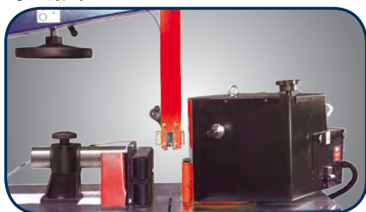
Mechanizm z pneumatycznym otwieraniem i bezstopniową regulacją prędkości VSA 260 CPM
