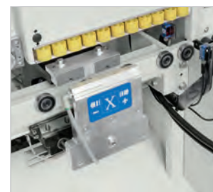
Pneumatyczny ogranicznik pozycjonowanego elementu
