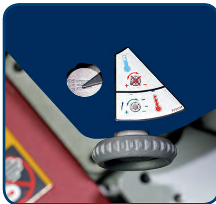
Pokrętko do regulacji ilości nakładanego kleju.
