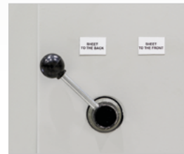
▶ Zmiana kierunku zrzutu blachy za pomocą dźwigni (tył/przód)
