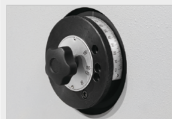
Seryjny sterownik MA, ręczna regulacja kąta gięcia za pomocą pierścienia skalowanego z lewej strony maszyny
