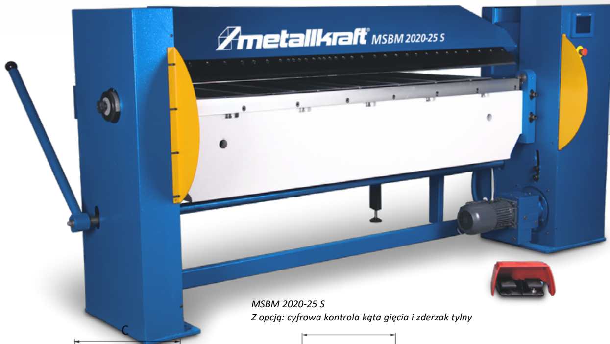
Seryjny sterownik MA, ręczna regulacja kąta gięcia za pomocą pierścienia skalowanego z lewej strony maszyny
