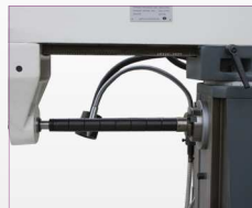
Pozioma pozycja frezowania • Do prac w poziomej pozycji freza z podtrzymką (okularom) oraz trzpieniem długim do frezów tarczowych
